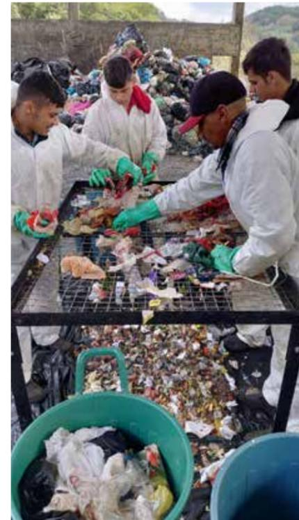
Abb. links Sortierung der angelieferten Haushaltsabfälle aus der Gemeinde Bento Gonçalves: Separation mit einem 40 mm Sieb
