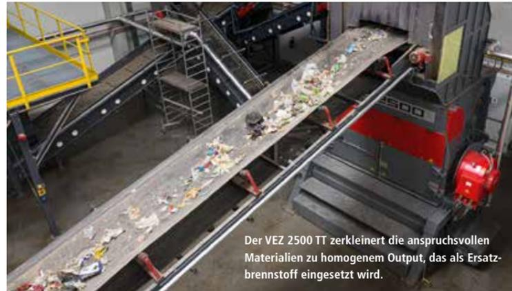
Der VEZ 2500 TT zerkleinert die anspruchsvollen Materialien zu homogenem Output, das als Ersatzbrennstoff eingesetzt wird.
