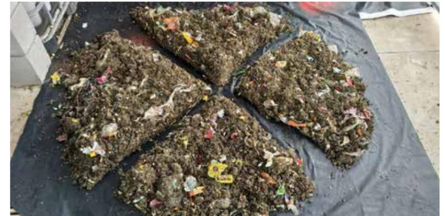
Abb. rechts Durchmischung der gesiebten Abfälle (< 40 mm) für die tägliche Probenentnahme zur Untersuchung des Heizwertes, des Asche- sowie Feuchtigkeitsgehaltes.
